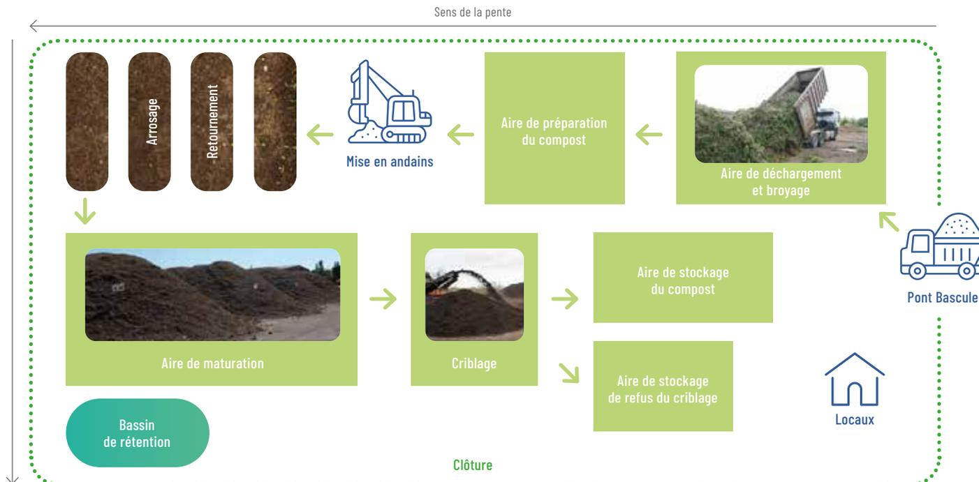
Afin de déterminer au mieux les quantités et types de déchets entrants, l'acquisition d'un **pont à bascule** est nécessaire. Les déchets selon leur nature seront ensuite stockés dans des aires spécifiques avant d'être broyés. L'acquisition d'un **chargeur** est alors nécessaire. Les déchets seront ensuite **broyés** et mis en andains. Les andains doivent être retournés afin de permettre une bonne oxygénation. Cela se fera à l'aide d'un **retourneur**.
