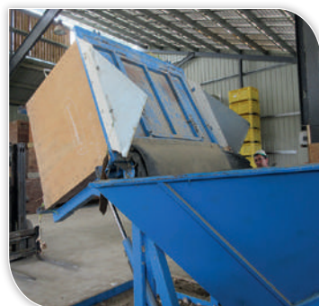
Inclinaison du palox et bloc de protection lors du déchargement
