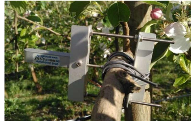
Les dendromètres posés sont de la marque Ecomatik®, le modèle choisi est le Diameter Dendrometer Small (DD-S), il peut être utilisé sur des petits arbres et des branches, son diamètre maximal étant de 5cm. Son exactitude est  $\pm 1.5 \mu\text{m}$  et sa précision entre 0.2 - 2.6 $\mu\text{m}$ .
