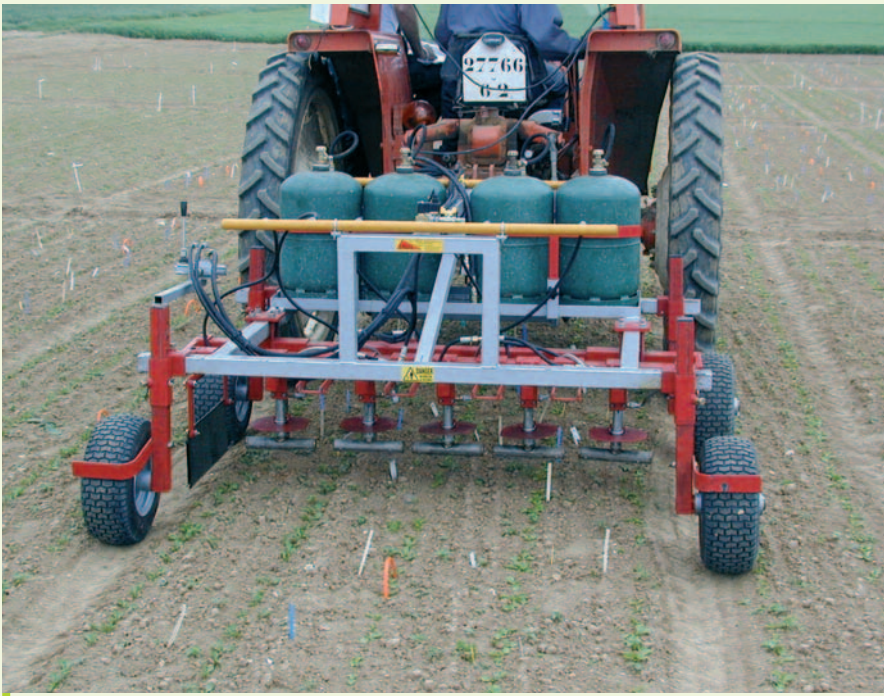
L'endive résiste bien au désherbage thermique car elle possède une racine pivotante contrairement aux adventices à racines fasciculées.
