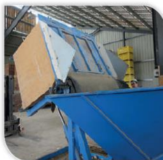
Inclinaison du palox et bloc de protection lors du déchargement
