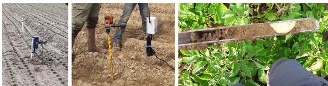
Sondes tensiométriques connectées, sonde capacitive connectée, humidité du sol sur 25 cm à l'aide d'une gouge – Photos CA31
