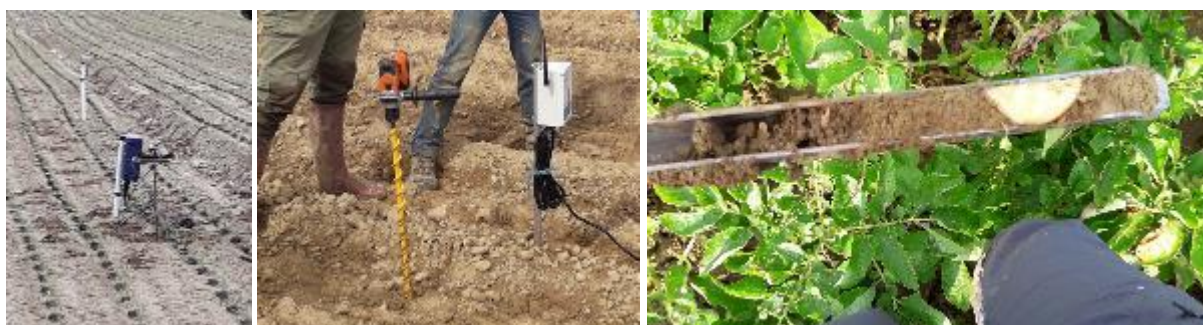
Sondes tensiométriques connectées, sonde capacitive connectée, humidité du sol sur 25 cm à l'aide d'une gouge – Photos CA31
