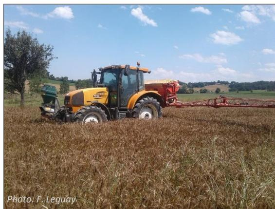
Distributeur d'engrais à rampe à transport pneumatique combiné avec un distributeur à la volée
